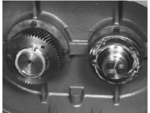
FIGURE 7-26 – INTALL HUB & PINION PULL TIGHT
