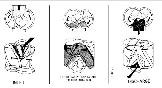
FIGURE 1 - OPERATING PRINCIPLE
