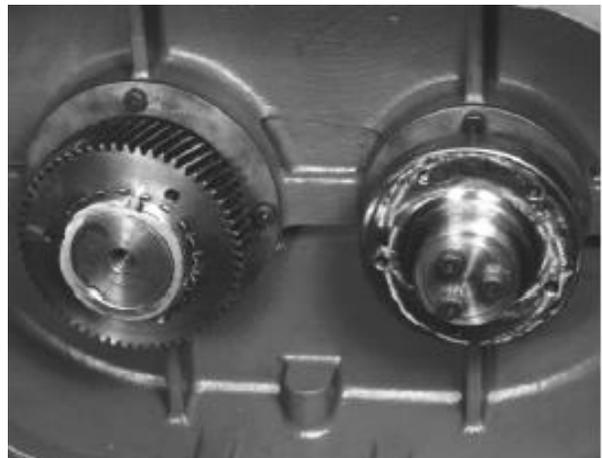
**FIGURE 7-26 – INTALL HUB & PINION PULL TIGHT**
