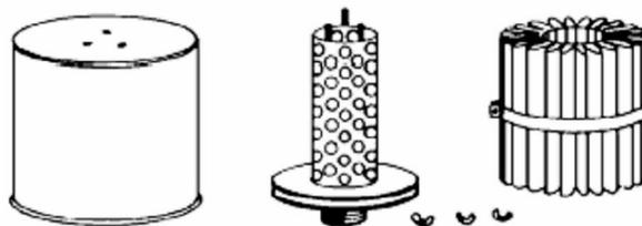
**FIGURE 4-6 – DRY TYPE FILTER AND FILTER-SILENCER**
